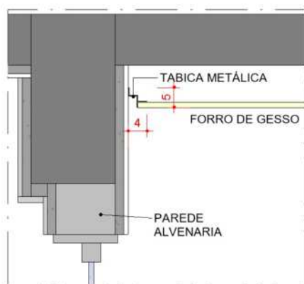
Figura 104 - Detalhe da tabica metálica no forro de gesso
